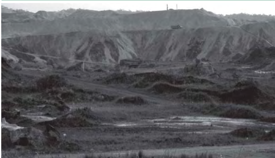
Huepetube. Zona de explotación por shute-cargador frontal. Se observa volquete transportando material hacia tolva ubicada en la parte superior.
